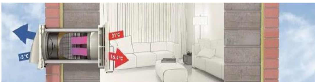
Installation af Varmeventilator i murværk
